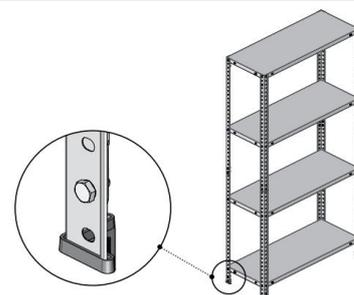
7. Стеллаж поднять в вертикальное положение и установить на ровную поверхность. С помощью уровня добиться вертикального положения стоек и горизонтального положения полок. Затянуть все соединения гаечным ключом.
