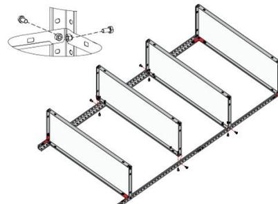
5. Сверху на полки аналогичным способом (см. п. 3) закрепить остальные две стойки.
