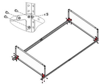
4. Установить дополнительные полки. Дополнительные полки крепятся к стойкам без усиливающих уголков, на 8 болтов и гаек.
